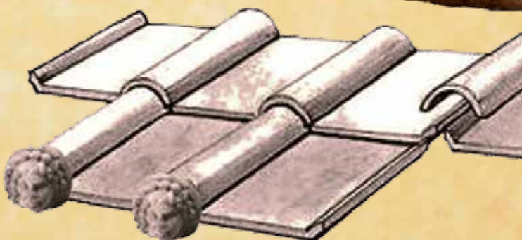
Antefisse a protome femminile dal santuario di Cittanova (fine III – inizio II sec. a.C.) e ricostruzione della loro collocazione originaria alle estremità dei coppi.
